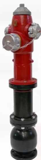
Hidrante de columna seca de 4" (DN100) con 1 salida de 100 mm + 2 salidas de 70 mm. Toma recta a tubería. Incluye carrete de 300mm. MOD. FP\_HYD\_C\_4
