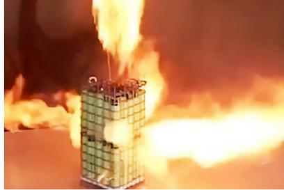
Una celda puede alcanzar temperaturas elevadas por un fallo termico, el electrolito se inflama y libera oxígeno. Se produce un incremento de la temperatura en bucle llamado Desbordamiento Térmico. Pudiendo llegar a los 1000°C en incendios de muchas horas.
