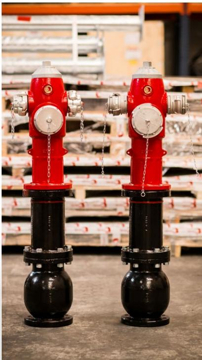
Hidrante de columna, con vaciado automático para protegerlo contra heladas. Fácil conexión de mangueras y equipos de lucha contra incendios. Con una salida de 4" racor bombero + 2 salidas de 2 1/2" con acoples Barcelona de aluminio forjado. Uso exclusivo bomberos.
