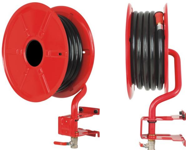
R.I.A pivotante sin armario para ser montada directamente a pared, en interior de hornacinas o en armarios multifunción. Incluye la devanadera DEV-pivotante equipada con 30 mts de manguera semirrígida en PVC de 25 mm en color negro, válvula de bola de latón cromado de 1" accionada por palanca, lanza latón con recubrimiento de resina y soporte easy-fit-pivotante de fijación.
