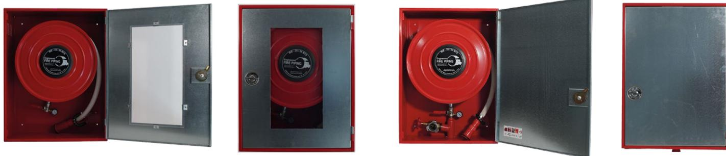
BIE completa basada en la devanadera DEV, montada en el interior de un armario con puerta practicable y preparado para fijarse en la pared. Caja de armario en acero (e=0.8 mm - galva). Puerta con bisagras ocultas en chapa (e=1 mm - pintada), ciega o con ventana. Cierra de aluminio empotrado en la pared con tirador abatible.
