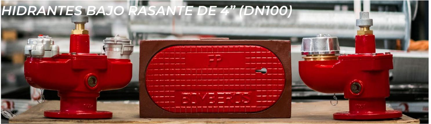
Hidrante de incendios instalado bajo tierra, con 1 o 2 salidas según UNE 23400. Entrada recta a tubería embridada DIN PN-16 de 4". Pintado en rojo. Producto marcado CE conforme Directiva Productos de la Construcción 89/106 CE y fabricado conforme a Norma UNE-EN 14339.
