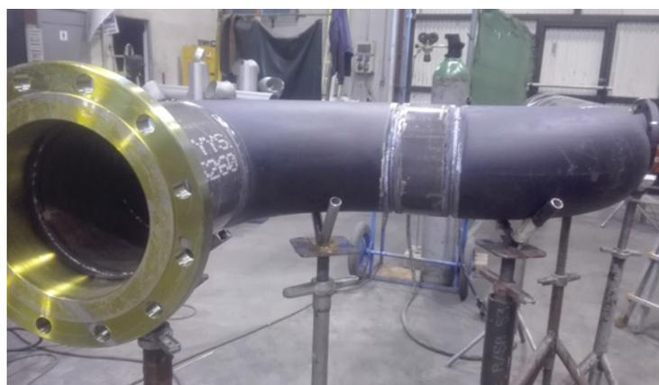
Fabricación de colectores para Salas de Bombas, Alimentación de Sistemas de P.C.I.
