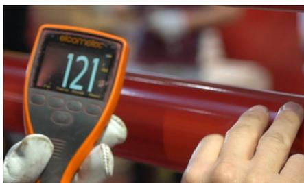
Pruebas de espesor de capas
